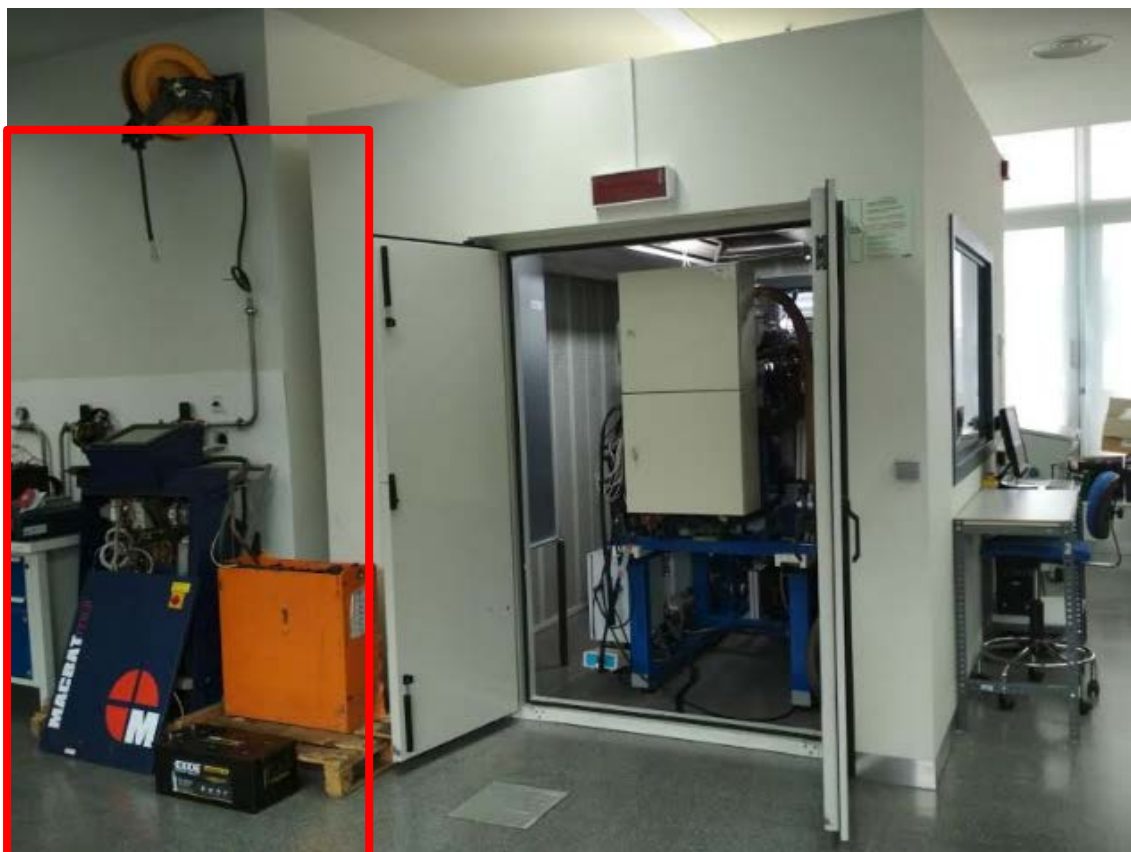
Ilustración 3. Celda banco motor laboratorio gas renovable
